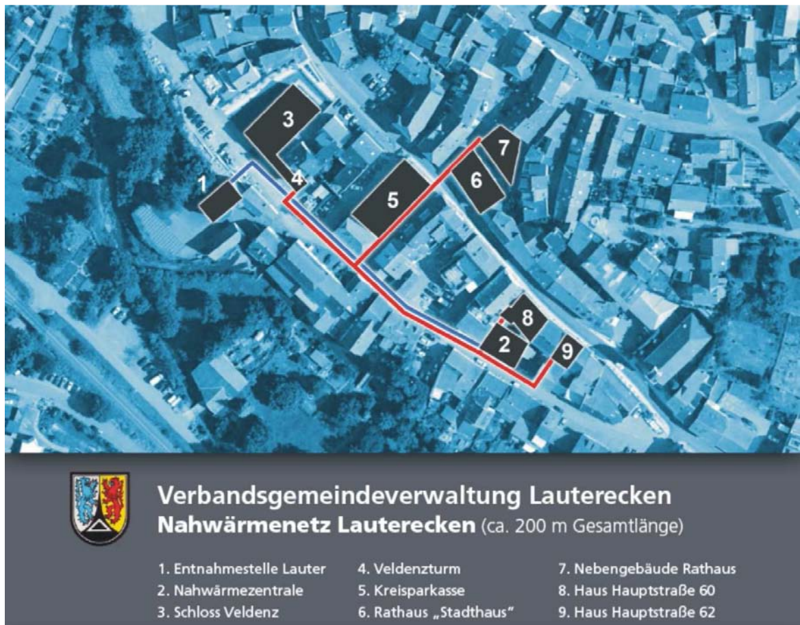
Abbildung 13: Übersichtsplan des Nahwärmenetzes Lauterecken (Quelle: www.thermea.de )
